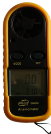
Gambar 3. Alat pengukur kecepatan angin ( Anemometer )
