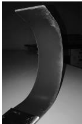
Gambar 5. Hasil bending ACP Sumber: Dokumentasi Pribadi 2019
