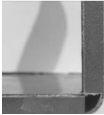
Gambar 7. Tampak samping hasil dari grooving ACP Sumber: Dokumentasi Pribadi 2019
