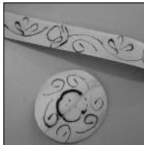
Gambar 5. Hasil Eksperimen Deboss menggunakan Besi yang Dipanaskan. Sumber : dokumen pribadi redaksi
