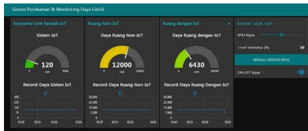
Gambar 3. Sistem perekaman daya listrik dalam prototype ruang
