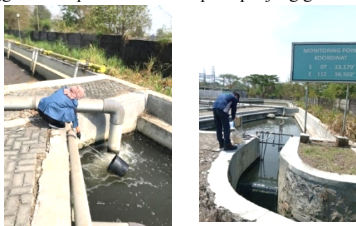
Gambar 1. Sampling Air Limbah pada Inlet (kiri) dan outlet (kanan) IPAL Kawasan Industri NIP
