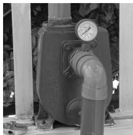
Gambar 2. Pompa NS-50 sebagai turbin
