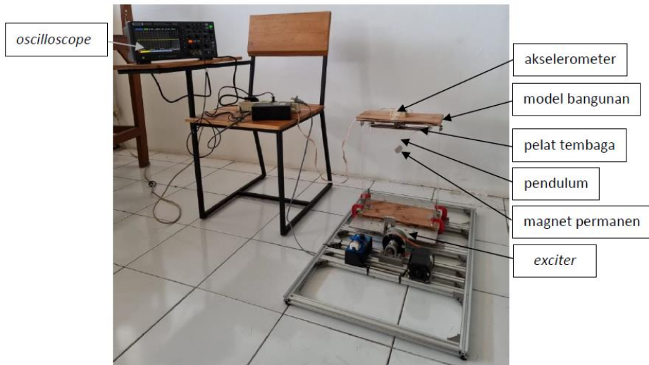
Gambar 1. Setup pengujian model bangunan dengan ECPPTMD.
