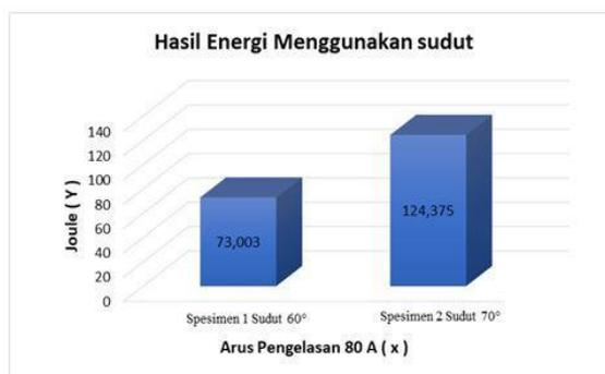
**Gambar 2.** Hasil uji Spesimen Arus 80A dengan sudut kampuh 60° dan 70°
