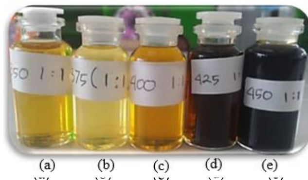
Gambar 2. Hasil produk biofuel Stearin dengan perengkahan katalitik
