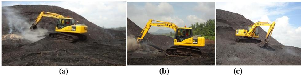
Gambar 4, a) Tahapan Pembongkaran *Stockpile*, b) Pemisahan Abu, c) Pemadatan *Stockpile*
