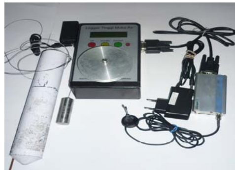
Gambar 4. Hasil Rancangan Unit Pemantau Tinggi Muka Air
