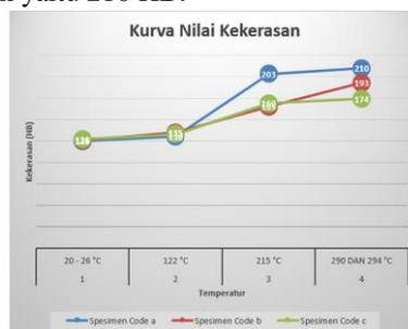
Gambar 4. Kurva nilai kekerasan pada spesimen
