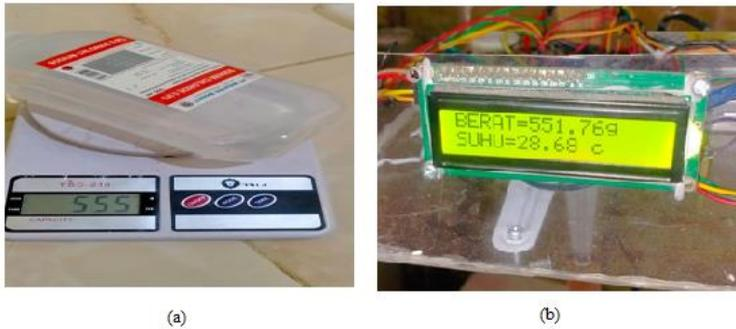
Gambar 3. Kalibrasi Load Cell (a) Timbangan Digital, (b) hasil pembacaan load cell
