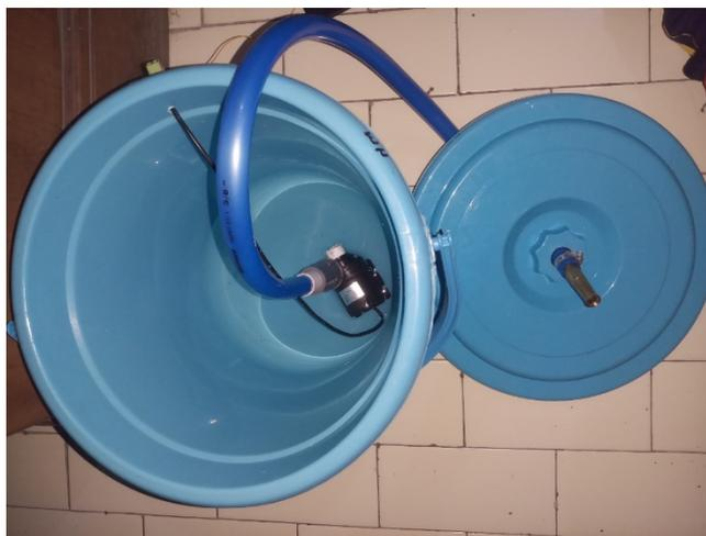
Gambar 5 Rangkaian Pompa Air Dengan Selang Spray
