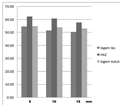
Gambar 4. Distribusi kekerasan didaerah las akibat variasi tebal pelat pada arus pengelasan 275 A.
