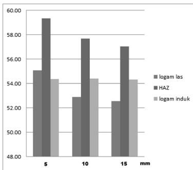
Gambar 2. Distribusi kekerasan didaerah las akibat variasi tebal pelat pada arus pengelasan 175 A
