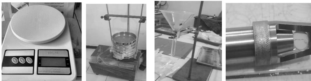
Gambar 1. Peralatan pengujian : timbangan digital, sieve shaker, corong uji sifa alir, uji kekerasan
