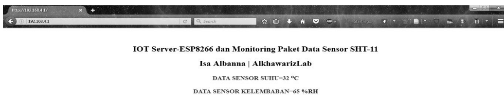
Gambar 5. Tampilan data IoT-WSN Monitoring suhu dan kelembaban.
