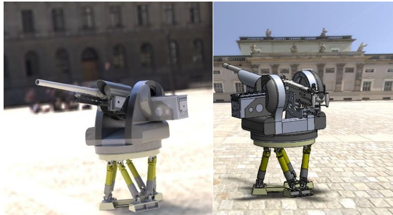
Gambar 6. Senjata RCWS diinstal pada Hexapod
