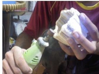
Gambar 5. Proses penghalusan dengan gerinda
