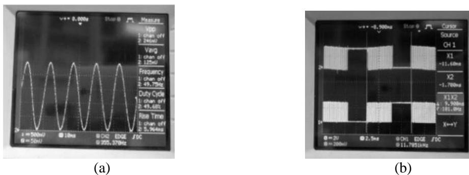
Gambar 7. a) Bentuk signal referensi 50Hz, b) Bentuk Pulsa SPWM 50 Hz
