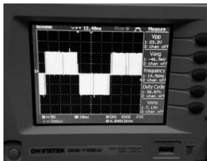
Gambar 9. Bentuk gelombang Output Inverter
