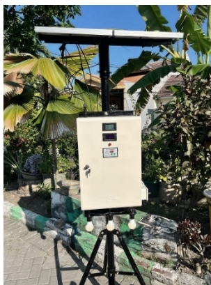
Gambar 8. Penggunaan PV Optimizer dengan Beban yang terhubung secara Seri
