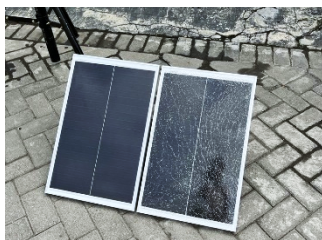
Gambar 6. Kondisi PV Normal dan Abnormal
