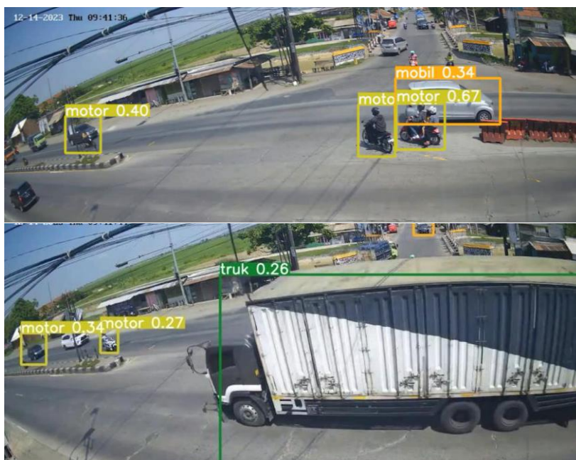
Gambar 5. Hasil Deteksi menggunakan YOLOv5
