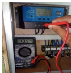
Gambar 6. Tegangan Baterai (accu) Saat Pengisian
