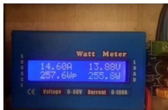
Gambar 9. Pengukuran Panel Surya Menggunakan Watt Meter.
