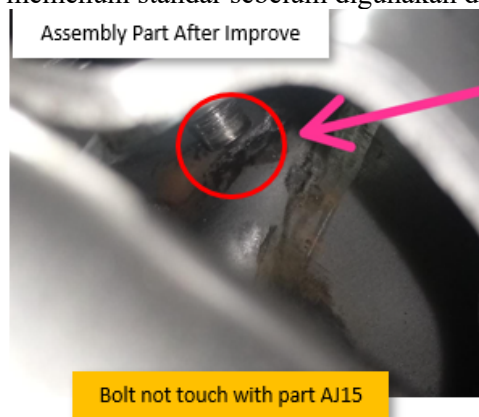
Gambar 5. Setelah penyesuaian DH dan perbaikan dies (baut tidak menyentuh AJ15) Sumber : Dokumentasi pribadi
