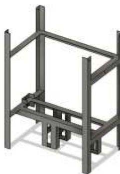
**Gambar3** Desain 3D Rangka Mesin Pencuci Dan Peniris Rumput Laut
