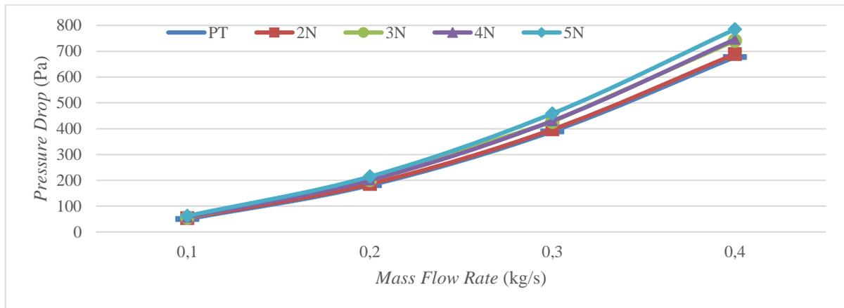
Gambar 6. Grafik *pressure drop* dalam berbagai variasi desain dan *mass flow rate*
