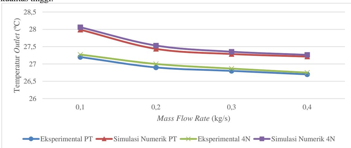
Gambar 4. Grafik validasi hasil eksperimental dengan hasil simulasi pada variasi PT dan 4N
