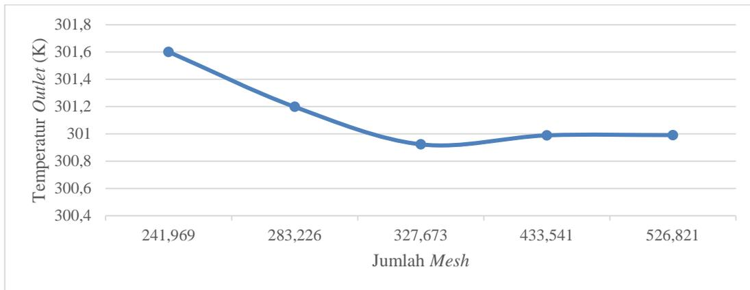
Gambar 3. Grafik Mesh Independency Test variasi PT pada mass flow rate 0,1 kg/s
