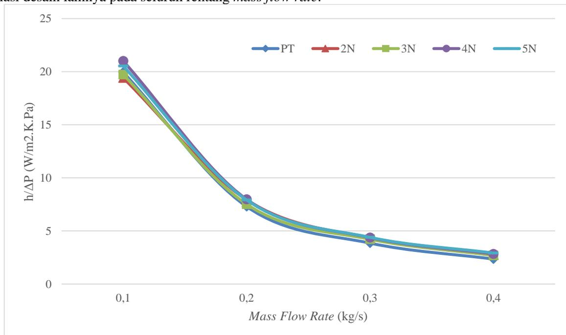
Gambar 7. Grafik nilai koefisien perpindahan kalor konveksi per *pressure drop* dalam berbagai variasi desain dan *mass flow rate*
