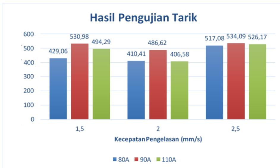
Gambar 1. Ultimate Tensile Strength (MPa) pada seluruh variasi pengelasan
