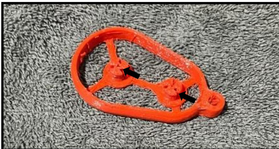
Gambar 7. Cacat pada komponen *frame*
