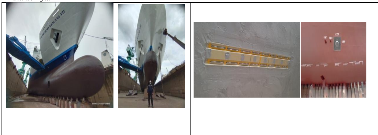
Gambar 3. a) Proses dockiing KM. Dharma Kencana VII, b) Proses pemasangan ICCP KM Dharma Kencana VII
