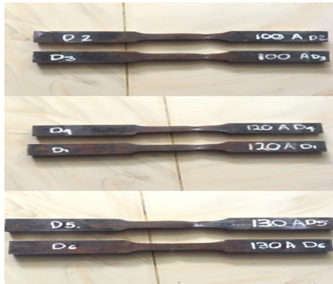
Gambar 5. Spesimen uji tarik setelah pengujian
