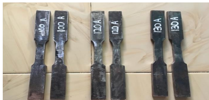
Gambar 4. Spesimen uji tarik sebelum pengujian
