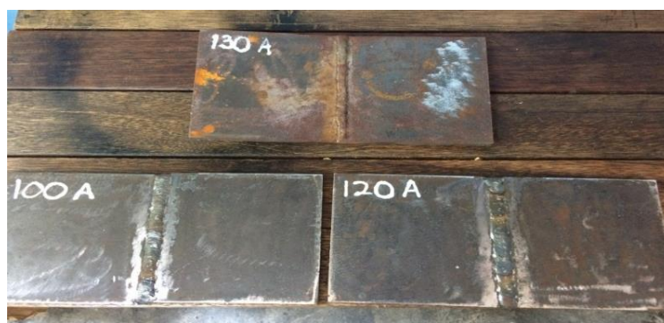
Gambar 2. Hasil pengelasan dengan arus 100 A, 120 A, dan 130 A
