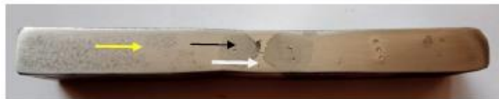
Gambar 9 Titik indentasi pada posisi pengelasan 2G dengan tipe elektroda E316 dan diameter 3,2mm
