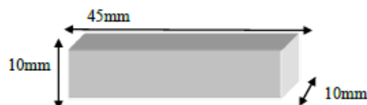
Gambar 1. Dimensi Spesimen yang akan di Las
