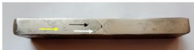
Gambar 5 Titik indentasi pada posisi pengelasan 1G dengan tipe elektroda E308 dan diameter 2,6mm
