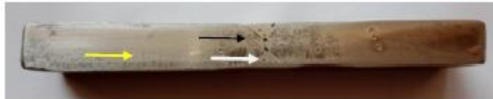
Gambar 8 Titik indentasi pada posisi pengelasan 1G dengan tipe elektroda E316 dan diameter 3,2mm
