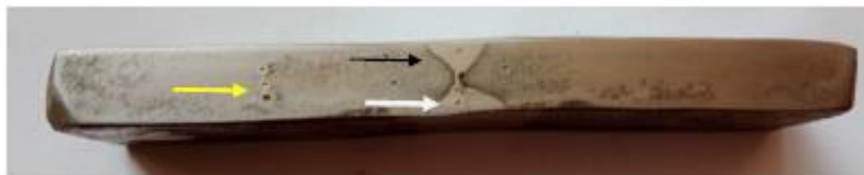
Gambar 10. Titik indentasi pada posisi pengelasan 2G dengan tipe elektroda E316 dan diameter 3,2mm
