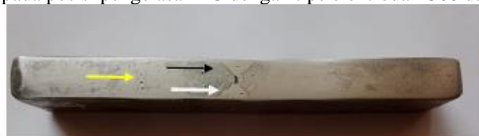
Gambar 6 Titik indentasi pada posisi pengelasan 2G dengan tipe elektroda E308 dan diameter 2,6mm
