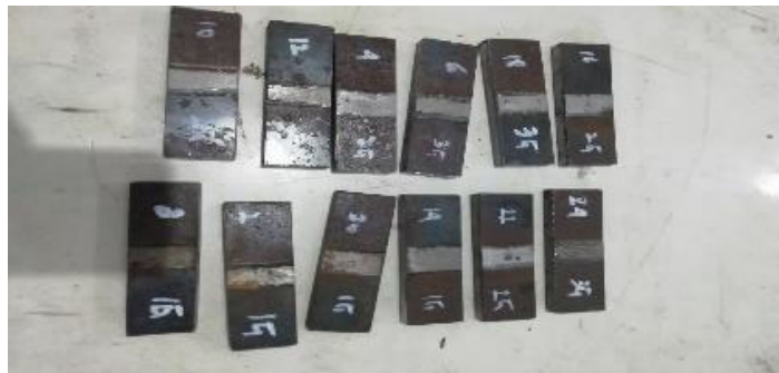
Gambar 6. Spesimen untuk Uji kekerasan (vikers)
