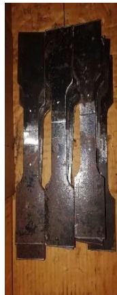
Gambar 4. Spesimen untuk Uji Tarik
