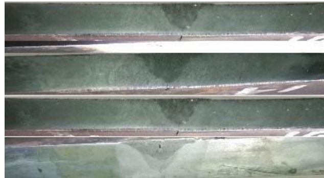
Gambar 7. Spesimen Foto Struktur Makro
