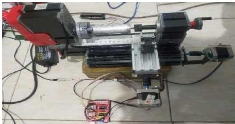
Gambar 4. Rangkaian Sistem Kontrol Pada Mesin Lathe Mini
