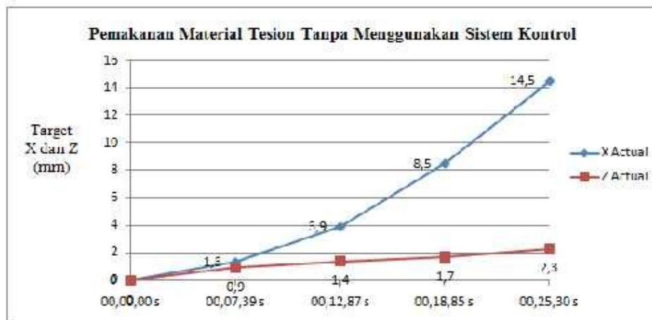
Gambar 6. Uji performa pemakanan dari material tesion tanpa menggunakan sistem kontrol
