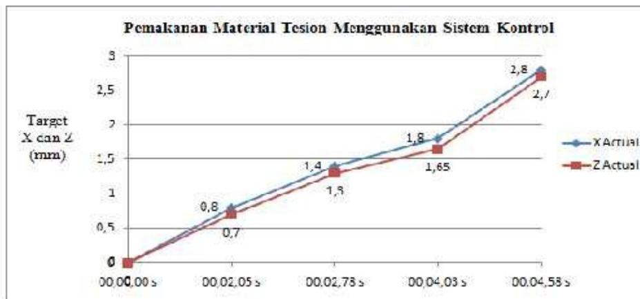
Gambar 7. Uji performa pemakanan dari material tesion menggunakan sistem kontrol
