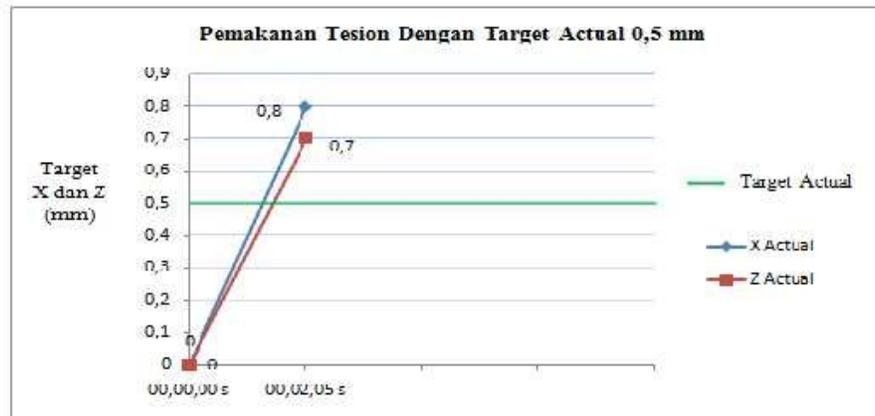
Gambar 11. Grafik Pemakanan Dengan Target Actual 0,5mm Pada Material Tesion Menggunakan Sistem Kontrol
