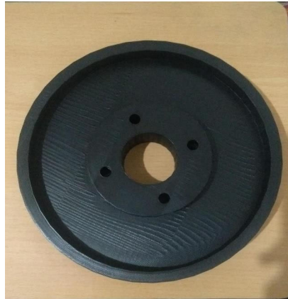
Gambar 12. Prototipe pulley motor induksi diameter 23 cm
