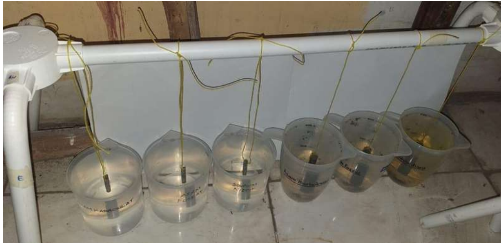
Gambar 1. Baja bertulangan diatur dalam posisi menggantung saat dimasukkan ke media korosif HCl
