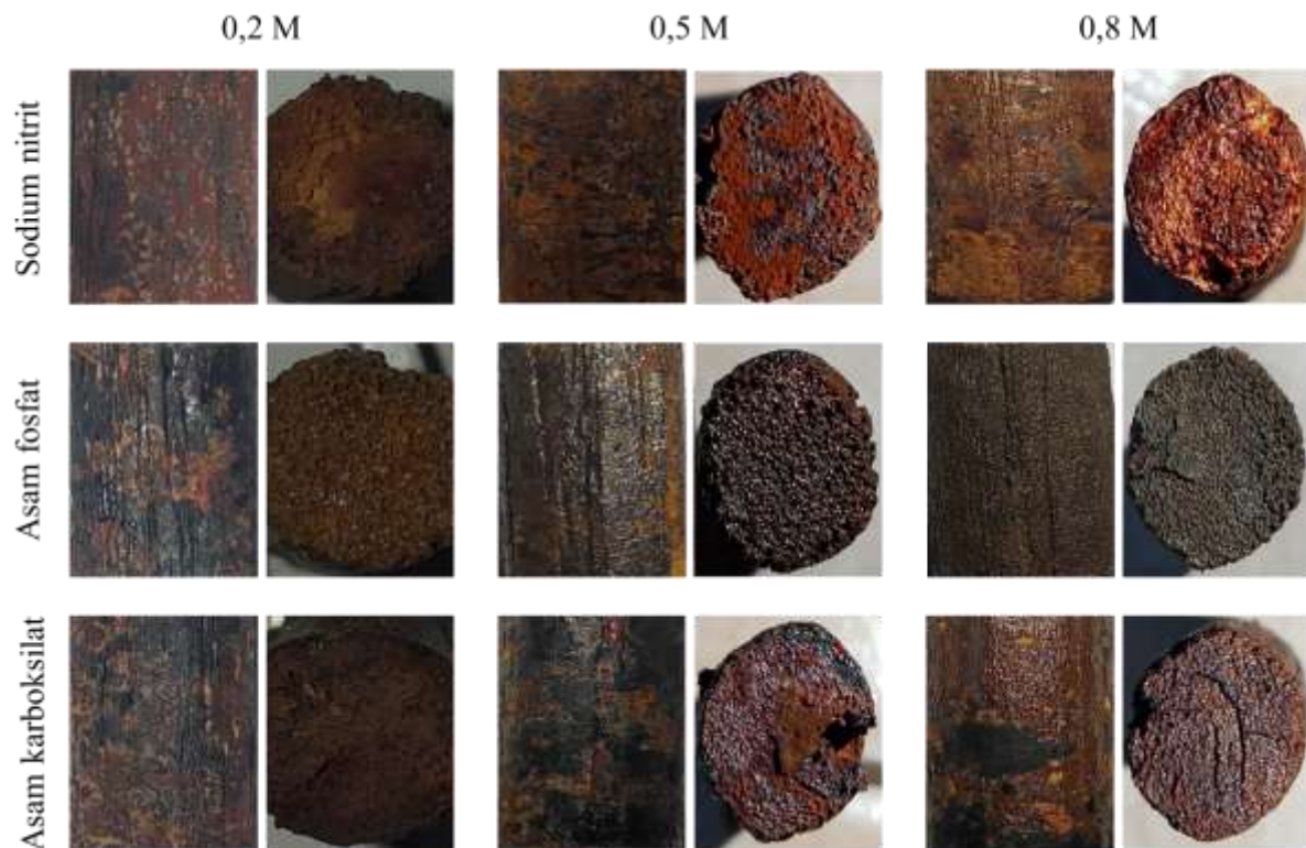
Gambar 2. Tampak morfologi dari tiap spesimen setelah dilakukan proses korosi,
