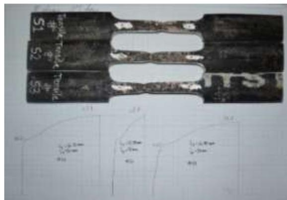
Gambar 3. Sampel Uji Tarik dan Hasil Kurva Tegangan Regangan.
