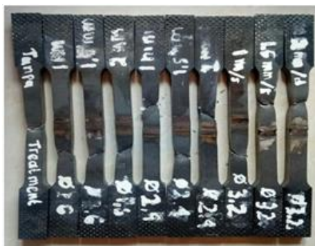
Gambar 2. Patahan pada spesimen uji tarik
