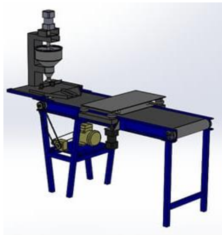
Gambar 1. Mesin Pembulat Adonan Kosmetik dengan Sistem Putaran Eksentrik
