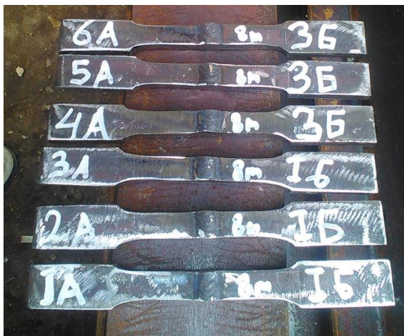
Gambar 3: Pelat SA36 tebal 8mm
