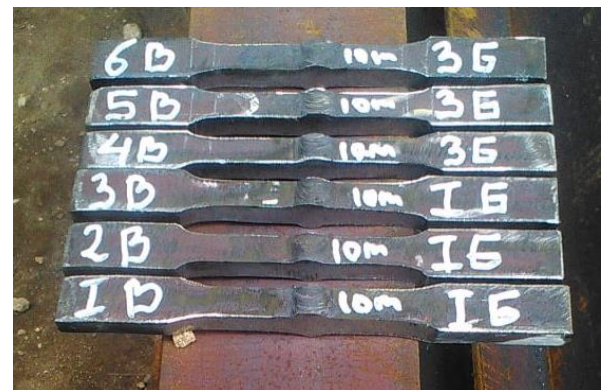
Gambar 4: Pelat SA36 tebal 10mm
