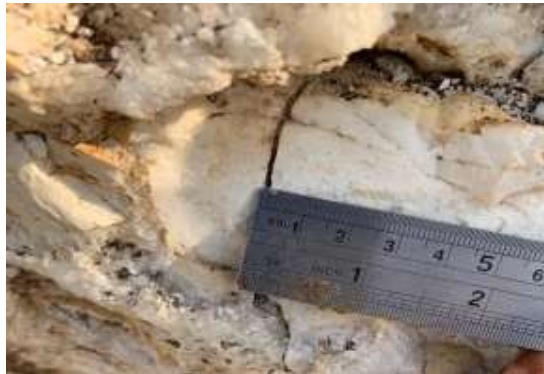
Gambar 6 : Kondisi Pelapukan Kekar Pada Lereng Penelitian (a) Agak Lapuk, (b) Pelapukan Sedang dan (c) Tidak Lapuk
