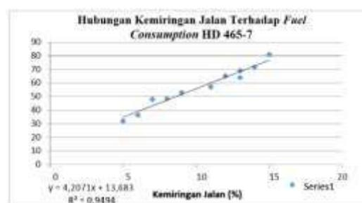
Gambar 2. Hubungan Kemiringan Jalan Terhadap Fuel Consumption HD 465-7
