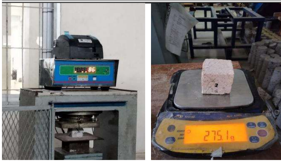
Gambar 2 : Uji Kuat Tekan
