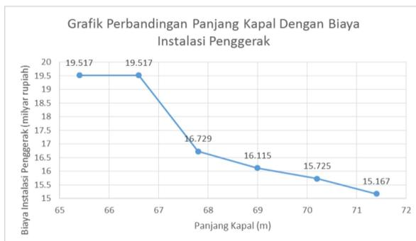
Gambar 7: Grafik Perbandingan Panjang Kapal Dengan Biaya Instalasi Penggerak.
