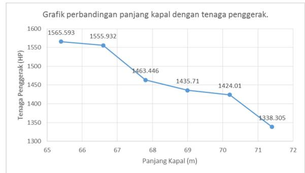
Gambar 4: Grafik Perbandingan Panjang Kapal dengan Tenaga Penggerak.
