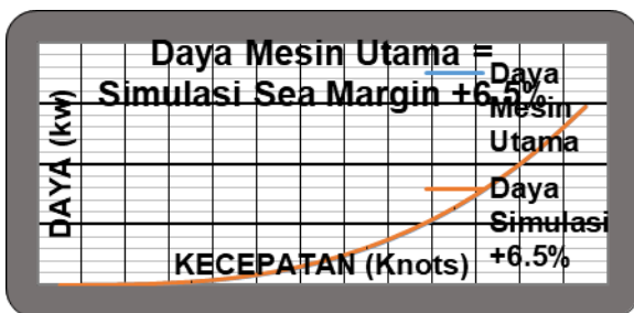
Gambar 17: Daya Mesin Utama Kapal – Simulasi Sea Margin +6.5%.
