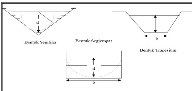
Gambar 1: Bentuk-bentuk penampang saluran
