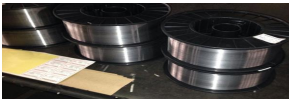
Gambar 13: Kawat Las FCAW NSSW E71T-1
