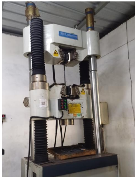
Gambar 3. Alat Tes Tarik dan lentur Hydraulic Universal Testing Machine di PT Universal Steelindo Dinamika (USD).
