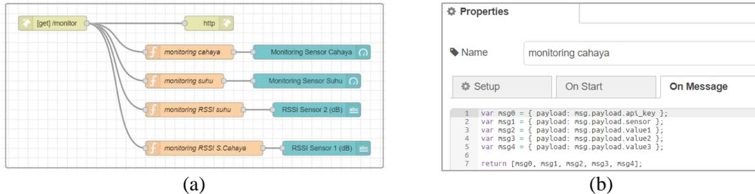
Gambar 1. a) Diagram alir untuk penyusunan program *block* dalam Node-Red, b) Pemrograman JavaScript untuk pengambilan data objek dalam *block-function* Node-Red [8].
