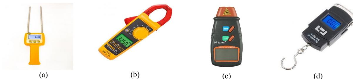
Gambar 1. (a) Moisture Meter, (b) Tang Ampere, (c) Timbangan Gantung Digital, dan (d) Tachometer
