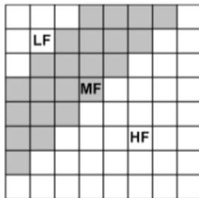
**Gambar 4.** Pembagian Koefisiensi DCT untuk ukuran Blok 8x8
